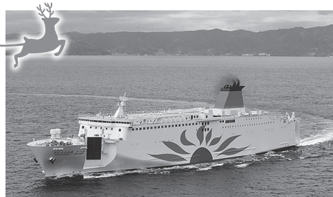
就航船舶 さんふらわあ きりしま (総)数13,659ト 全長192m 巾27.0m
