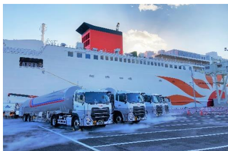
LNG燃料の補給風景 国内初・トラック4台同時に補給しております。
